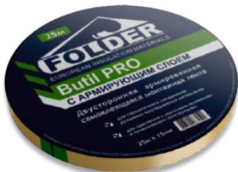
Folder Butil Pro - это армированная двусторонняя монтажная лента из бутилкаучука с армирующим слоем из стеклосетки. Применяется для соединения полотен изоляционных материалов и герметизации мест примыкания изоляционных материалов к оконным и дверным проемам, трубам и вентиляции, стропильным конструкциям и т.п.
