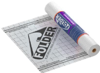
Folder Anticondensat - трехслойная гидро-пароизоляционная пленка повышенной прочности с антиконденсатным слоем. Специальный влагопоглощающий слой равномерно распределяет конденсат по материалу, препятствуя его стеканию на теплоизоляцию.
